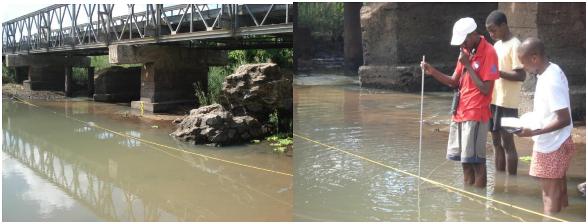
Fotografia 3.1 – Medição de caudal na estação E442 – Mopeia no rio Lungozi
