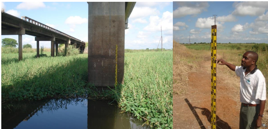
Fotografia 3.2 – Escalas hidrométricas na estação E403 – Mopeia no rio Cuácua
